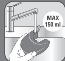
**DE** Befüllen Sie den Wassertank mit max. 150 ml reinem Leitungswasser.
